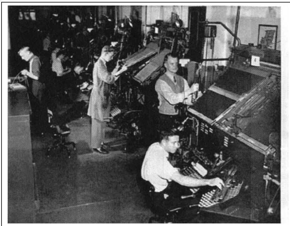
Figura 40 - Aprendizes operando Linotipo, década de 40 do século XX. Imagem obtida em Rochester Institute of Technology ( www.rit.edu ). Sobre o teclado em frente ao operador, está fixado um texto, sendo o original a ser reproduzido na fundição dos tipos.
