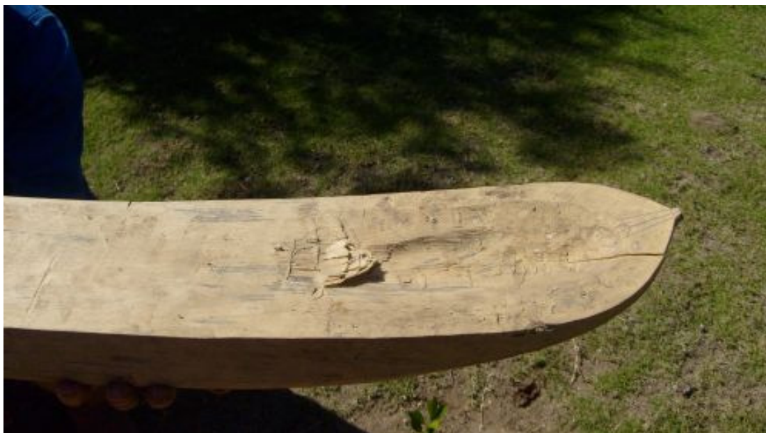
Figura 37: Madeira lascada cortada na lua “errada” em julho de 2008
